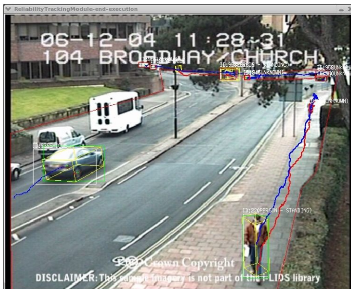
Фиг. 2. Определяне на вида на движещия се обект
