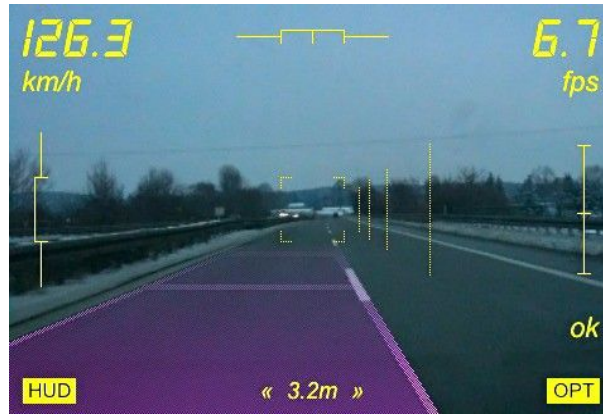
Фиг. 4. Следене на лентата на движение на автомобила
