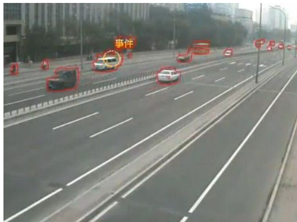
Фиг. 5. Единична камера покриваща няколко ленти и следяща за спрели автомобили
